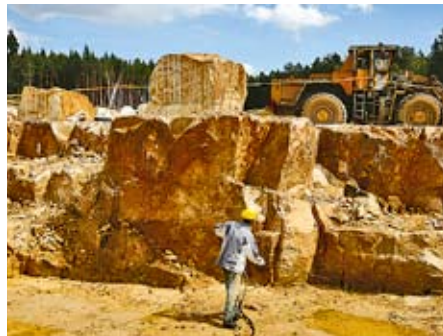
Obr. 21: Lom Kocbeře – vrtání stěny při těžbě blokového kamene
