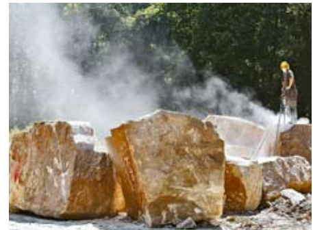
Obr. 22: Dělení a zarovnání blokového kamene před transportem
